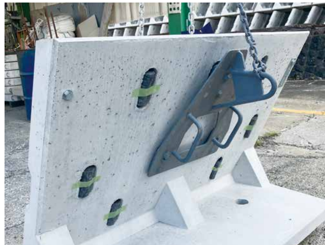
背面吊状況・連結プレート・吸出し防止剤設置状況 9孔／個
